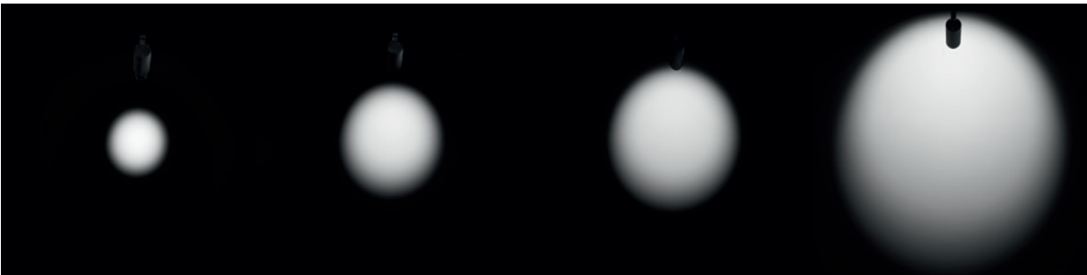
Abstrahlwinkel fokussierbar von 15° bis 90° / Beam angle focusable from 15° to 90°
